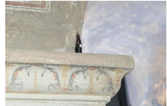
Sensore per il monitoraggio di temperatura
