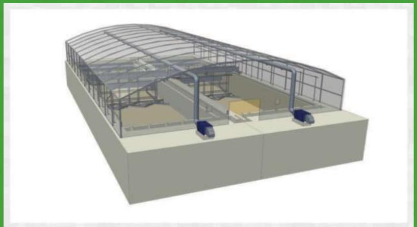
Tali trattamenti possono essere effettuati secondo cicli di funzionamento preordinati, continui oppure asservendo il macchinario alla tipologia della qualità dell'aria mediante sistemi di controllo in controreazione impieganti sonde in ambiente.
